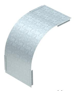
Deckel für fallende Vertikalbögen der Seitenhöhe 110. Die Befestigung wird durch die Überlappung der Kabelrinnendeckel gewährleistet. Zusätzlich kann der Deckel mit Deckelklammern befestigt werden.
